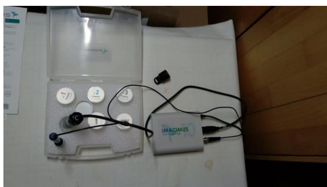
Il·lustració 40: Aparell IMACIMUS Multilon amb les dues sondes en medis condicionants
